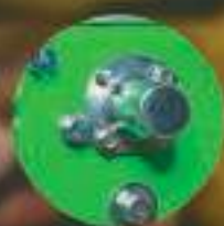
Вал отбора мощности для привода навесного оборудования имеет соединение под шпонку и диаметр 18 мм
